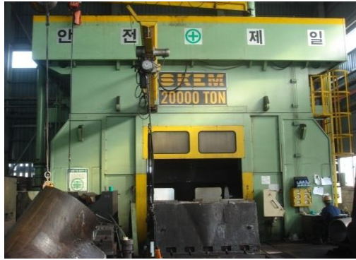
Tee Bulging Press 20,000 Ton
