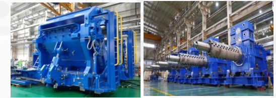
다운코일러 Down Coiler
