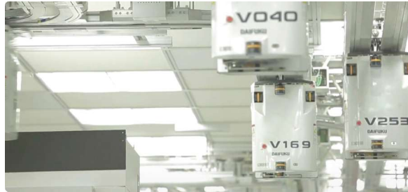
반도체 생산 라인 內 OHT 1 (Over Head Transport)
