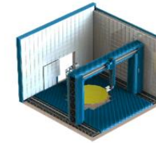
근접전계 측정 시설
