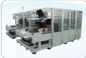
LCD 원판 Glass를 1매씩 공급하여 일정크기의 Stick Panel 또는 Cell로 분리하는 System으로, 한번에 8Line 동시 Cutting (중/소형 Glass 적용)
