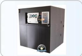
CAD/Scanning 등으로 3D 모델링된 부품을 레이저 LPBF 방식을 적용 가공하는 장비로, Powder 사용량 절감 및 적층 시간 단축, 높은 종횡비 제품 및 얇은 구조의 제품 제작이 가능
