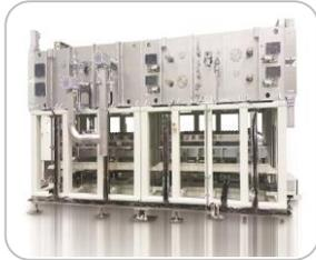
OL-TFE-G Series는 증착 이후 진공 및 N<sub>2</sub> 분위기에서 OLED의 손상 없이 Thin Film Encapsulation을 진행하기 위한 Chamber 및 Enclosed Box 등으로 이루어진 System이며, PECVD, ALD, Inkjet, 보호 Film Laminator, AOI (이물 검사기) 및 각종 검사기 등의 공정을 순서대로 진행
