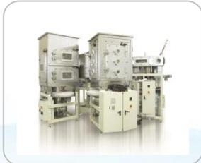
OL-VO-G Series는 OLED 증착 전 TFE Glass를 진공에서 Baking하여 세정 후 제거되지 않은 수분이나 기타 불순 물질을 Out-gassing 하기 위한 System이며, Far Infrared Heater가 적용 된 진공 Chamber는 ATM 열풍로 대비 TFT Glass의 Out-gassing 효과 우수
