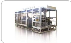
Bended Lamination System은 OLED Module 공정 설비로서, Flexible Glass의 PAD/COF/FPC를 후면으로 Bending 후 부착하는 설비
