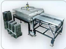
MOCVD(Metal Organic Chemical Vapor Deposition) 장비는 CIGS Solar Circuit에 일정한 두께로 TCO(ZnO) 층을 증착하는 장비
