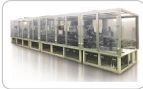
Back Film Lamination System은 OLED Module 공정 설비로서, Flexible Glass를 보호하기 위해 하부에 Film(Back Plate)을 Lamination하는 설비
