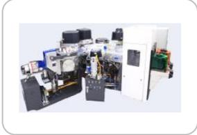
최첨단 반도체 금속 배선 공정(RDL)부터 언더 범프(u-Bumping) Metallization 같은 패키징 응용 분야에 이르기까지 다양한 증착 기능을 제공하는 Cluster Type의 장비로, PVD/Pre-clean/Etch/Degas Chamber로 구성되며, 패키징 공정의 박막 증착 Solution 제공
