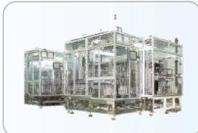
Panel의 상/하 표면에 편광판을 부착하는 Automatic Lamination 설비로, POL은 세정 후 Stage에 자동으로 공급하고 보호 Film을 박리하며, 자동 공급된 Panel은 Vision Align 후 Roller 압착 방식으로 편광필름과 Panel을 자동 부착하는 설비
