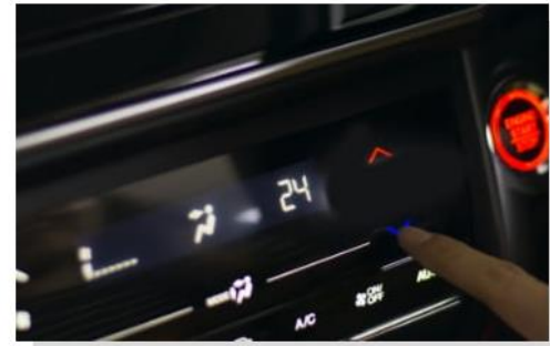
터치식 공조기 (HVAC)
