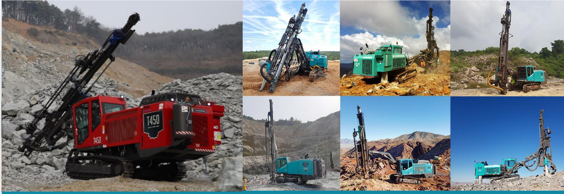
Blast-hole Drill rig 발파용 천공기
